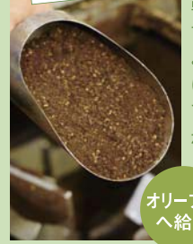
脱水した搾りかすを100kg型と50kg型の乾燥機でかくはんしながら乾燥させます。100度の熱風で約8時間。天日干しをしていたころは手作業でかきまぜながら2週間もかかったそうです。
