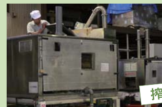
脱水した搾りかすを100kg型と50kg型の乾燥機でかくはんしながら乾燥させます。100度の熱風で約8時間。天日干しをしていたころは手作業でかきまぜながら2週間もかかったそうです。
